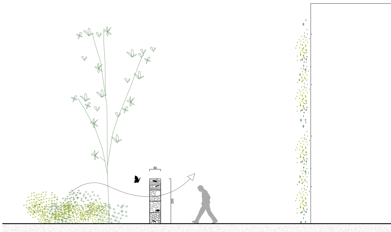
Coupe détail d'un gabion
